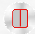
A partir de 105, refuerzo 1 barra de 40x30x1.5
